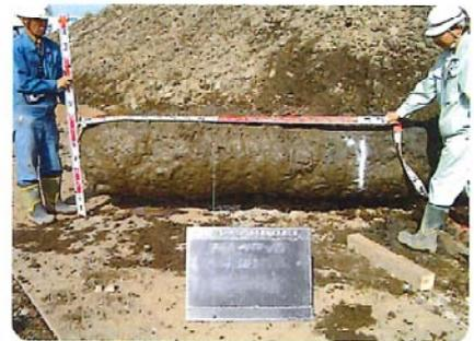
杭径φ450mm掘出試験結果
